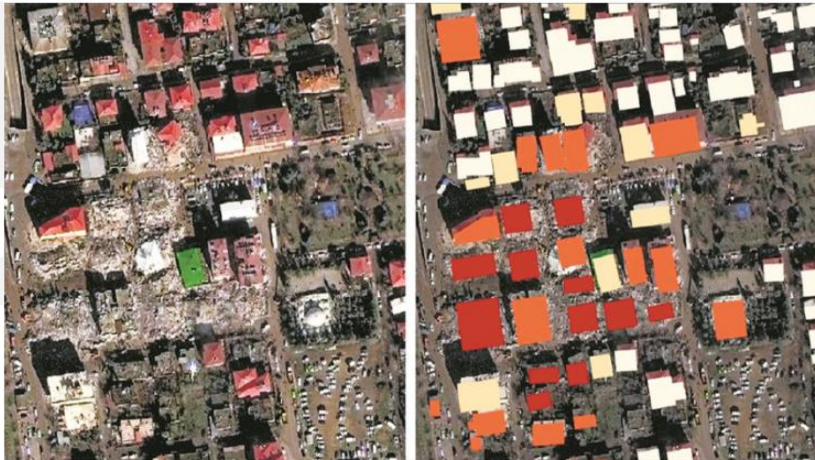
Islahiye - xView2, che analizza le immagini satellitari, mostra le aree più gravemente danneggiate in rosso scuro. (Sinistra - Immagine satellitare / Destra - Analisi View2)
